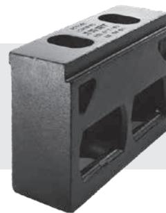
Die Befestigungsbeschläge werden mit Wechselkoffer, -pritsche oder Container verschweißt. Mit den Befestigungsbeschlägen wird der Wechselbehälter mit dem Fahrzeug oder Anhänger verbunden.
